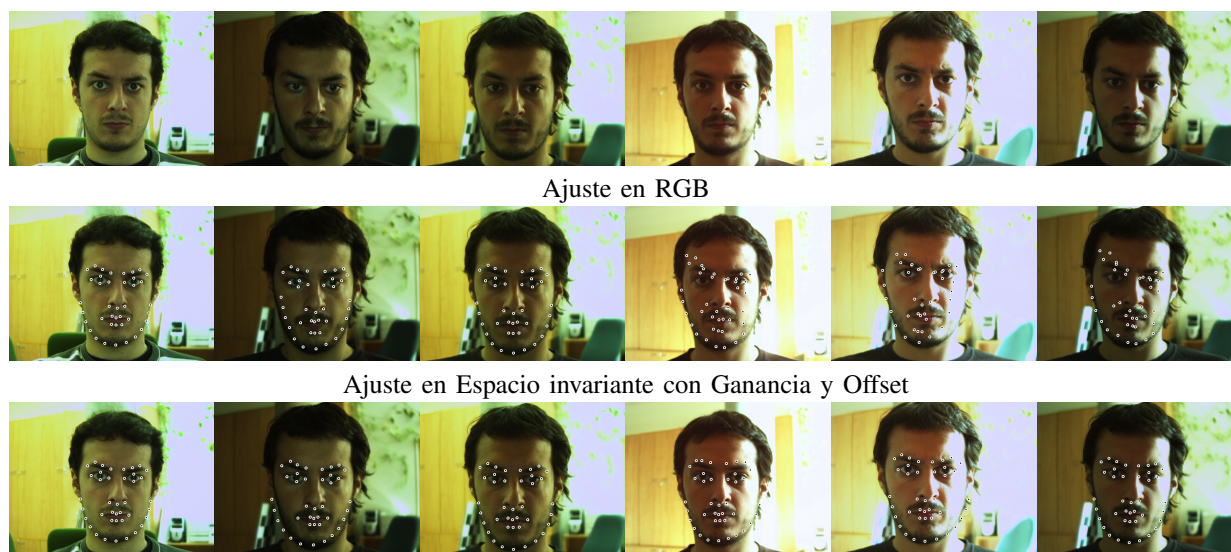
Figura 6. Resultado del algoritmo de ajuste en imágenes con distinta iluminación y usando diferentes algoritmos.
