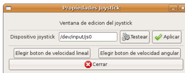
Figura 7.3. Ventana de edición de los parámetros del joystick.
