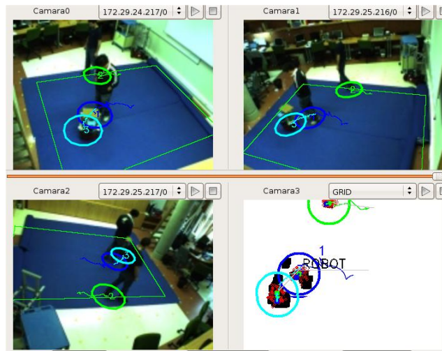
Figura 7.10. Aspecto de la aplicación cuando se está realizando el seguimiento, mostrando tres cámaras y el GRID.
